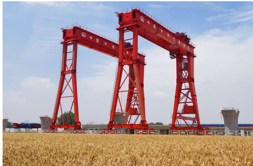
5月19日,中铁七局平漯周川汇制梁场900吨跨线提梁机圆满完成拼装任务,标志着该项目即将开始687孔箱梁提梁作业。(郑州公司 王润宇 摄影报道)
